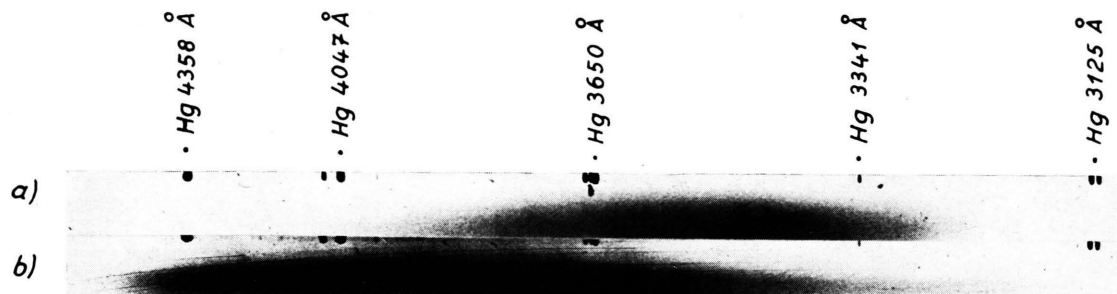
Abb. 3. Diphenyl ( C_6H_5 ) 2 . Konstant: Stromstärke 5 mA, He-Druck 0,8 mm Hg, Temperatur des Entladungsrohres 300° C. Variabel: Temperaturbad des Diphenyls, a) 80° C; b) 76° C.
